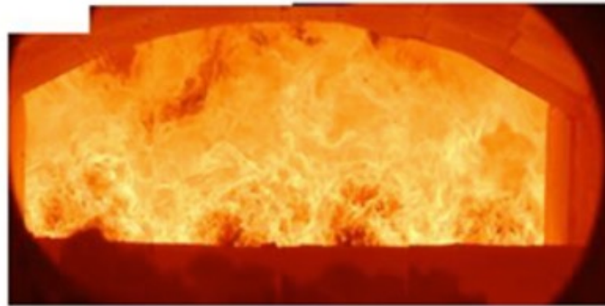
窯ガス専焼化の燃焼状況
